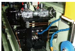
圧延機(圧延ロール)
